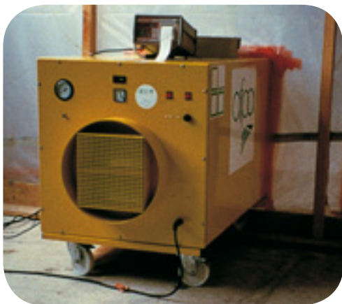
Extracteur d'air et système d'enregistrement.
