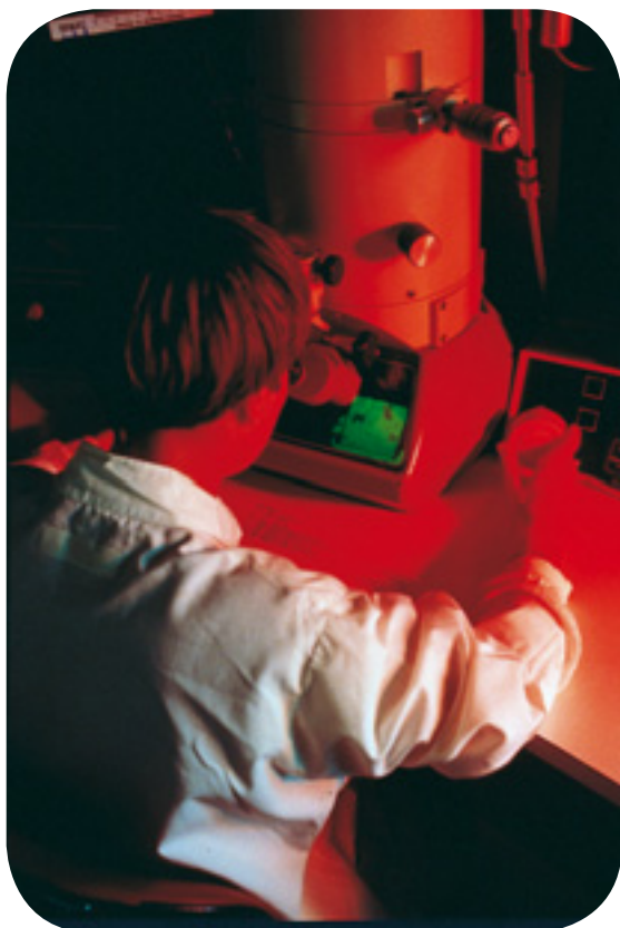
Le microscope électronique à transmission (META) permet à la fois de dénombrer les fibres collectées lors d'un prélèvement d'atmosphère et de vérifier la nature des fibres observées.
