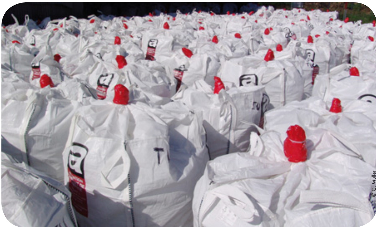
Fermeture en col de cygne des GRV.
